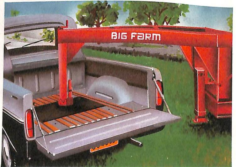
O encaixe de Big Farm em sua pick up é extremamente simples. Basta fixar a placa com a esfera de engate no veículo, baixar o braço Big Farm e trancá-lo através de uma chave manual. Sistema fabricado sob licença de Steady Sistem, Illinois, U.S.A.\*
