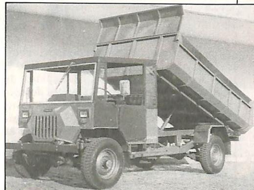
**TRATOR BASCULANTE** — A Tramontini está no mercado com a CAT-2000 basculante, um caminhão-tractor de pequeno porte para transportar até duas toneladas de carga, equipado com motor Agrale M790, de 36 cavalos-vapor. O fabricante aponta as vantagens sobre similares: valor de aquisição de cerca de 70 por cento inferior, manutenção simples, consumo de 25 quilômetros/litro diesel e tração 4 x 4. **Tramontini Implementos Agrícolas Ltda., Rua Borges de Medeiros, 26, CEP 95960, Encantado, RS.**
