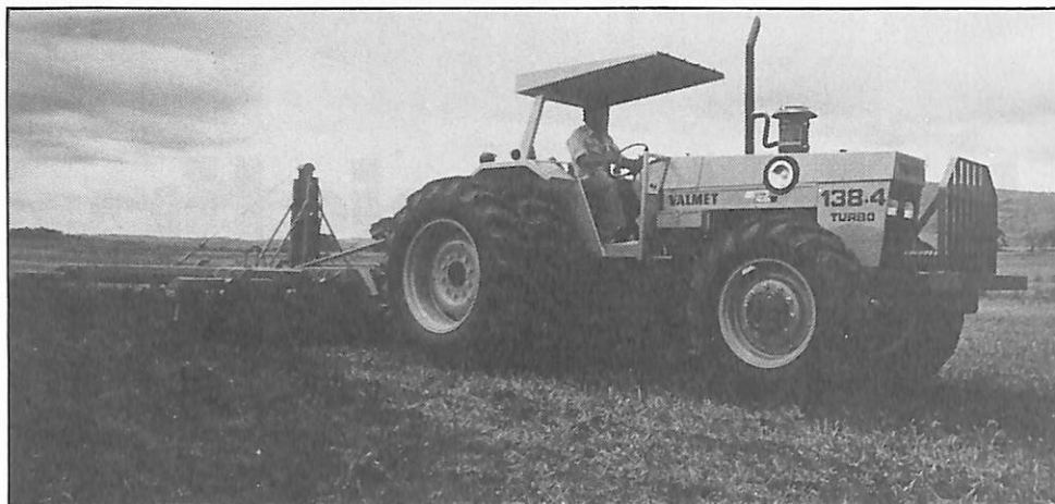
Uso excessivo de grades pesadas reduz infiltração de água e facilita a erosão
