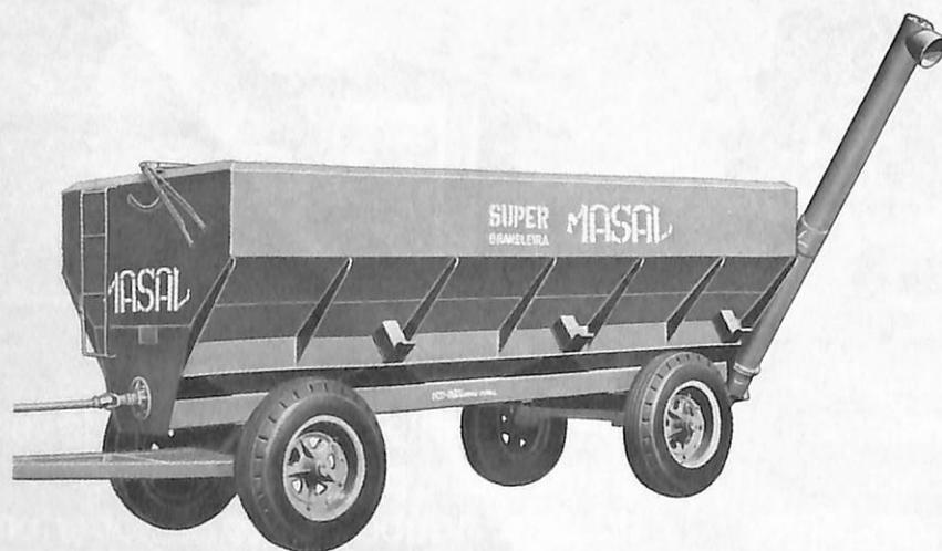
CARRETA GRANELEIRA - (4 RODAS) a solução para o transporte ou armazenamento temporário de grãos na própria lavoura durante a colheita. Fabricada em 5 versões com capacidades para 5.000, 8.000, 10.000, 12.000 e 15.000 quilos, proporciona descarga rápida por gravidade nas laterais ou por caracol (rosca sem fim) acionado na tomada de força do trator.
