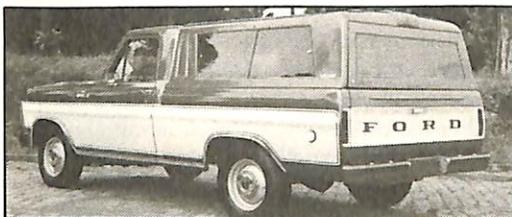
**CAPOTA** — Para camionetas Ford, toda de fibreglass, vidros temperados de correr, peso de 55kg, altura de 66cm, totalmente vedada, capacidade de dois metros cúbicos, em diversas cores e com sistema exclusivo de fechadura. **Manfro, BR 116, km 123,3, caixa postal 367, CEP 95100, Caxias do Sul/RS.**
