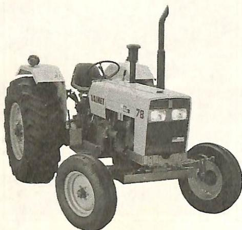
**TRATOR 73CV** — A Valmet está no mercado com o modelo 78 da linha de tratores Série Prata, com 73 cavalos. Possui câmbio sincronizado com seis velocidades à frente e duas à ré, motor MWM D229-4VE a diesel com injeção direta, direção hidráulica hidrostática, embreagem simples com disco único, a seco, 310mm de diâmetro ou TPD independente (opcional) com dois discos, a seco 295/280mm. **Valmet do Brasil S.A.,** rua Verbo Divino, 1601, CEP 04719, São Paulo/SP.
