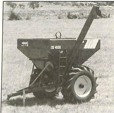
**CARRETA GRANELEIRA** — A CG 4000 é eficiente e resistente, com capacidade de quatro mil litros, comprimento de 3,75 metros e largura de 2,40 metros. Com peso total carregada de 3.450 quilos, é acionada por tomada de força e tem velocidade de descarga de 15 sacos por minuto. Fornecida nas cores laranja, amarela (Valmet) e azul (Ford). Altura de descarga: 3,35 metros. **Abicht Metalúrgica Ltda., rua Sete de Setembro, 675, CEP 97100, Santa Maria, RS.**
