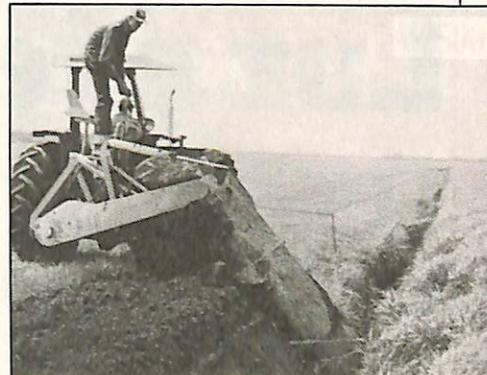
**VALETADEIRA-NIVELADORA** — Além de limpar, a valetadeira V.2500 da Bouwman realiza todo o trabalho de nivelamento das margens da valeta. Potência de 80Hp, acionada por tomada de força, comando hidráulico próprio da máquina, velocidade de 800 a 2.000 metros por hora, e profundidade de valeta de dois metros. **B. J. Bouwman - Indústria de Máquinas Agropecuárias, Colônia Castrolanda, CEP 84100, Castro, PR.**
