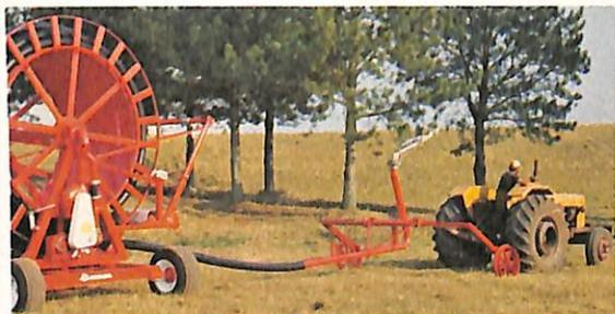
O tubo PEAD é facilmente desenrolado do carretel com o auxílio de um trator médio, deixando-o esticado conforme as linhas de operação, existindo um mecanismo direcionador que evita o serpentear do tubo PEAD.
