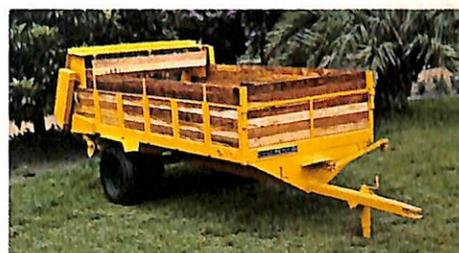
Seu sistema de distribuição do adubo por roscas traseiras cobre o terreno de maneira uniforme. Pode também ser utilizado na distribuição de silagem no cocho, mediante um opcional de descarga lateral.
