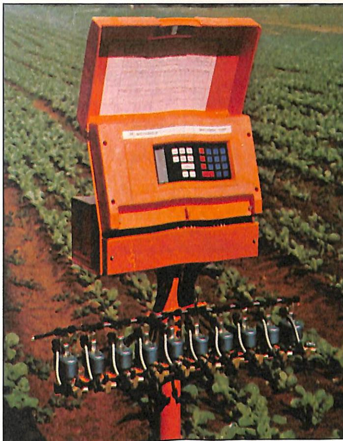
Processador eletrônico: água conforme o solo e o clima
