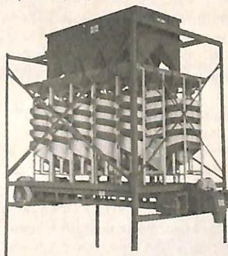
**SELECIONADOR EM ESPIRAL** — O selecionador em espiral Rota II foi projetado para complementar a limpeza da semente de soja, na fase final da operação de pré-limpeza. Separa os grãos chochos alongados, meio-grãos, sementes verdes e malformadas. Funciona por força centrífuga e gravitacional. **Rota Indústria de Máquinas Agrícolas Ltda.**, rua João de Barro, 175, CEP 86030, Londrina/PR, fone (0432) 23.5267, telex (0432) 462 MERO.
