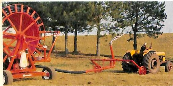
O tubo PEAD é facilmente desenrolado do carretel com o auxílio de um trator médio, deixando-o esticado conforme as linhas de operação, existindo um mecanismo direcionador que evita o serpentear do tubo PEAD.
