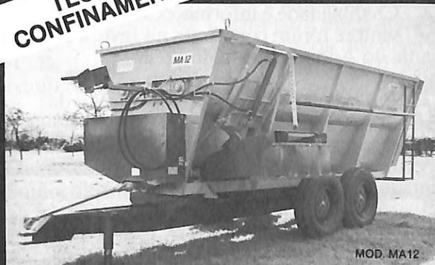
Aumente seus lucros em confinamento de gado usando a tecnologia CASALE. A Misturadora-Alimentadora Casale dosa, mistura homogênea e distribui silagens, grãos, concentrados, etc... A dosagem é feita através de balança eletrônica programável fornecida opcionalmente com a máquina.
