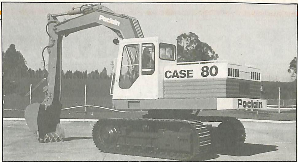
**ESCAVADEIRA** — Para terraplanagem em geral, extração e carregamento de minérios, abertura de canais para irrigação e drenagem, limpeza de córregos e assentamento de tubos para água e esgotos, a nova escavadeira Case 80 hidráulica apresenta tecnologia de alta pressão e manejo fácil. **J. I. Case/Poclair do Brasil, avenida Jerome Case, 1801, CEP 18000, Sorocaba/SP, fone (0152) 32-8933.**
