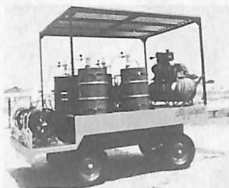
**CARRETA DE LUBRIFICAÇÃO AGRÍCOLA:** equipada com propulsoras pneumáticas e motor diesel. Fabricamos também para caminhão.
