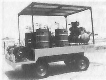
**CARRETA DE LUBRIFICAÇÃO AGRÍCOLA:** equipada com propulsoras pneumáticas e motor diesel. Fabricamos também para caminhão.
