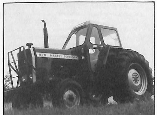
**CABINA** — Especial para pomares. Adaptável ao trator. Entre as especificações técnicas, destacam-se: estrutura metálica, vidros de segurança, luz de cortesia, limpador de pára-brisa elétrico, circuladores de ar turbinados, isolamento térmico no teto, visibilidade total e maior conforto para o operador. Cabinas Real Ltda., rua Demétrio Ribeiro, 494, caixa postal 341, fone (0512) 93-7611, telex (051) 2936, CEP 93300, Novo Hamburgo/RS.
