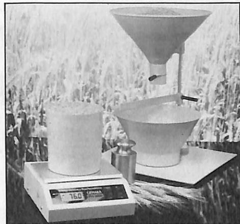
**Balança eletrônica** — Sem similar no mercado nacional, balança para a medição de Peso Hectolitro para produtos agrícolas é totalmente eletrônica e projetada para pesagens com carga máxima de três quilos, sensibilidade de uma grama, em três segundos. Funciona ligada à rede (110/220 volts) ou com pilhas de 1,5 volt. **Indústria e Comércio Eletro-Eletrônica Gehaka Ltda., avenida Duquesa de Goiás, 235, Real Parque, fone (011) 542-7488, telex 1130867, CEP 05686, São Paulo/SP.**
