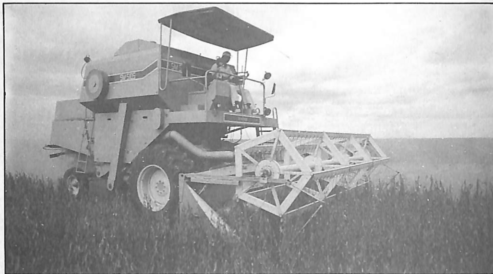
SM 5105 para colheita seca, com plataforma flexível para soja
