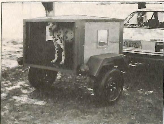
**Pequenos animais** — Chassi de construção metálica, com baú em madeira (compensado naval) ou em fibra de vidro, e suspensão independente, de braços oscilantes. Esta é a estrutura da carreta Hobby Way para transporte de cães e pequenos animais. Pintura sintética e engate para todos os tipos de veículos. **Hobby Way, rua Tangará, 35, Vila Mariana, fone (011) 549.2782, CEP 04019, São Paulo/SP.**
