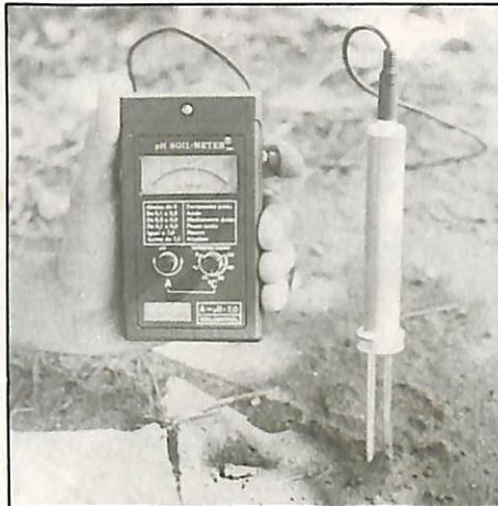
**Medidor de pH** — Fabricado em resina ABS, compacto, leve e resistente para ser usado no campo, o monitor pH Soil-Meter faz leituras a cada 20 segundos, permitindo detectar pH variável entre três e nove. Alimentado à bateria alcalina de nove volts, com sonda galvânica e visores analógicos. **Soilcontrol S/C**, avenida Adolfo Piniheiro, 2464, conjunto 72, 7º andar, CEP 04734, Santo Amaro, São Paulo/SP, fone (011) 251.1599.
