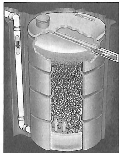
**Biodigestor** — Sistema anaeróbio, especial para tratamento de esgotos biodegradáveis. De acordo com o fabricante, o biodigestor Facis tem carga hidrostática mínima de 1Kpa, é compacto e não tem peças móveis. Sua instalação pode ser feita em conjuntos habitacionais, hospitais, escolas, laticínios, abatedouros, currais, entre outros. **Facis Tubos e Postes Ltda., rua Paulo Setúbal, 160, fone (0152) 32-0028, caixa postal 647, CEP 18100, Sorocaba/SP.**
