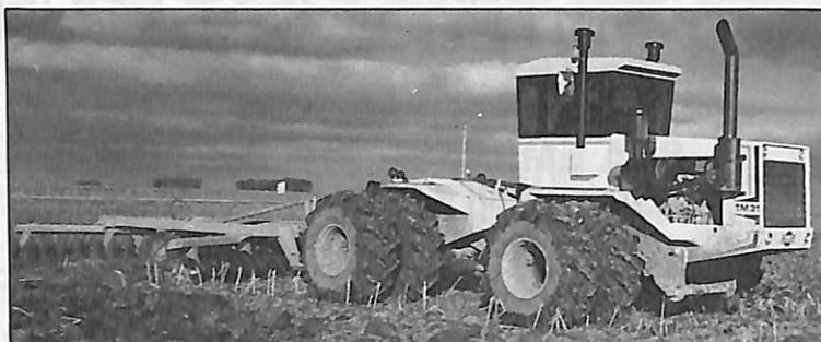
**Trator pesado** — Equipado com motor Scania DS 11 de 258Hp a 2.100rpm, o trator agrícola TM 31 4x4 da Müller realiza todas as etapas de preparo do solo com alto rendimento em menor espaço de tempo. Com transmissão mecânica, o trator tem capacidade de operar em vários tipos de terreno, mesmo alagadiço, irregular ou com declividade. Müller S.A., Indústria e Comércio, estrada Almirante Santiago Dantas, 485, CEP 21660, Rio de Janeiro/RJ.
