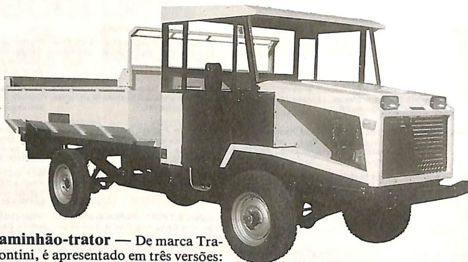
**Caminhão-tractor** — De marca Tramountini, é apresentado em três versões: carroceria de madeira, basculante e cabine dupla. A tração é 4x4, com marcha reduzida, e apresenta um consumo de 25km por litro de óleo. **Revendedor exclusivo: Sodima - Sociedade Distribuidora de Máquinas Ltda.**, rua Gaspar Martins, 267, CEP 90000, Porto Alegre/RS, fone (0512) 25-0144.
