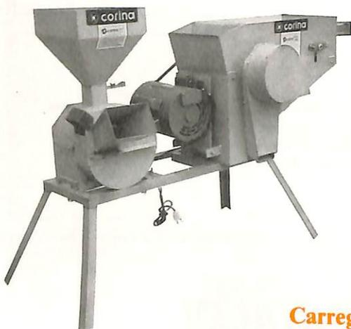
**Triturador/batedor** — Além de debulhar o milho, separando-o integralmente da palha e do sabugo, com capacidade variando de 360 a 480 quilos por hora, este equipamento pode também triturar milho em espiga, à base de 720 ou 1.020 quilos por hora. Acionado por motores de três a cinco cavalos-vapor. **Corina -Eletrô Mecânica Ltda.**, rua Senador Salgado Filho, 373, CEP 99900, Getúlio Vargas/RS, fone (054) 341-1753.
