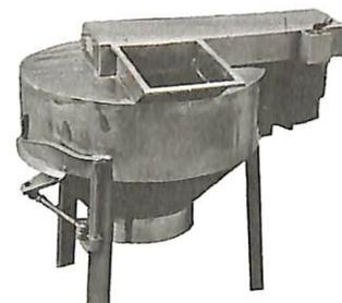
**Depenador** — Automático, tem capacidade para mil aves por hora (oito aves de cada vez) e é feito de aço inox, monobloco. Fechado com trava manual e dotado de 117 extratores de borracha flexível, o que evita machucar as aves. Motor elétrico de 2cv (110 ou 200 volts), dimensões de 0,90 x 1,20 metro, e peso líquido de 118 quilos. **Metoll - Ind. de Máquinas e Equipamentos Ltda.**, Jardim Santa Terezinha, 33 (Caixa d'Água), fone (071) 594-9349, Salvador/BA.
