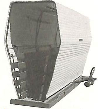
**Banheiro** — Para aplicação de carrapaticidas ou banhar animais, funciona através de motobombas elétricas ou a gasolina. A distribuição adequada dos bicos nebulizadores permite tratamentos sanitários em todas as partes do corpo do animal. O líquido excedente retorna ao depósito pelas canalatas laterais. Metax - Metalurgia, Comércio e Agricultura Ltda., BR 376, km 347, fone (0434) 22-3131, CEP 81500, Apucarana/PR.
