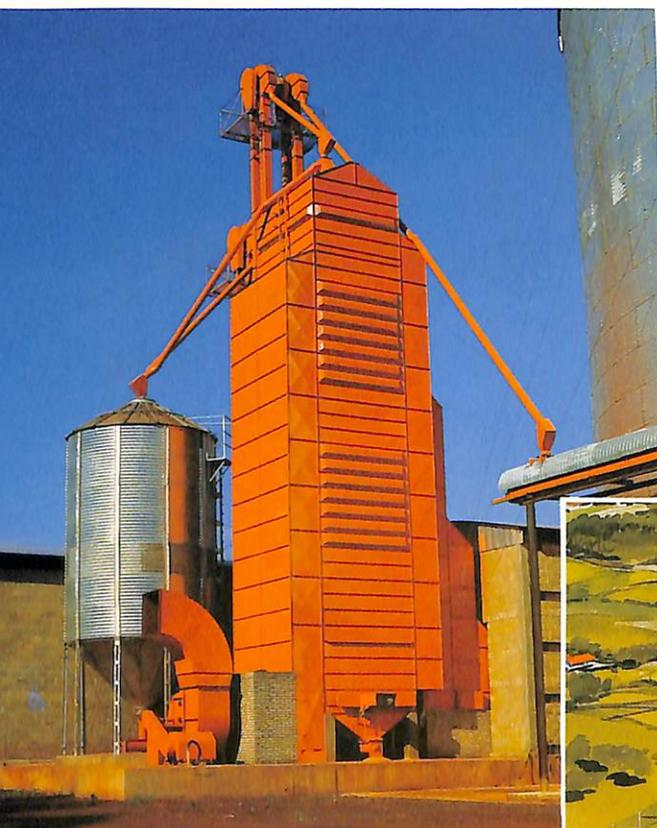
**SR-2310, uma revolução na secagem de grãos** - Operando com fluxo "concorrente", seca mais rápido e melhor a temperaturas entre 120 e 60°C. Capacidade de 20 t/h no processamento de arroz com casca, milho, trigo e soja.
