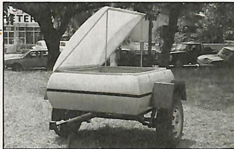
**Reboque** — Fabricado em plion (um novo material sintético que não quebra, não descasca, não enferruja e é impermeável), reboque com capacidade para 600 litros de carga ou 350 quilos. Montado sobre chassi de estrutura rígida com feixe de molas e amortecedores, para múltiplas aplicações: camping, transporte de peixes, camarões, frutas, verduras, líquidos e bagagens em geral. **Berco Acessórios Ltda.**, rua Alvorada, 196, fone (011) 542-4734, CEP 04550, Vila Olímpia, São Paulo/SP.
