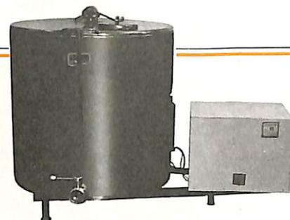
**Resfriador de leite** — Em aço inox, com parede dupla e isolamento de poliuretano injetado, tanque resfriador de leite equipado com guarda eletrônico para manter a temperatura exata. Capacidade variando de 250 até 5.300 litros. **Eugapec Implementos Pecuários Ltda., rodovia Marechal Rondon, km 394, caixa postal 152, fone (0142) 72-1591, CEP 16600, Pirajuí/SP.**
