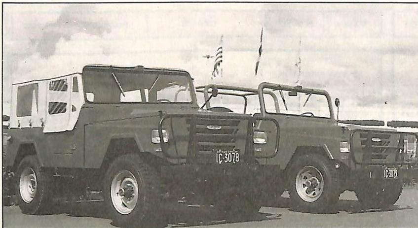
**Utilitário** — Dotado de motor diesel, quatro tempos, com potência de 72cv/DIN a 2.600rpm e torque máximo de 25mkgf/DIN a 1.500rpm, o utilitário "Javali" é fabricado em metal (carroceria) e lona (capota). Quatro marchas à frente mais ré, peso total de 2.000 quilos (700 de carga) e tanque com capacidade para 60 litros. **CBT - Companhia Brasileira de Tratores, avenida São Luiz, 50, 30º andar, CEP 01000, São Paulo/SP, fone (011) 257-2322, telex 11-21267.**
