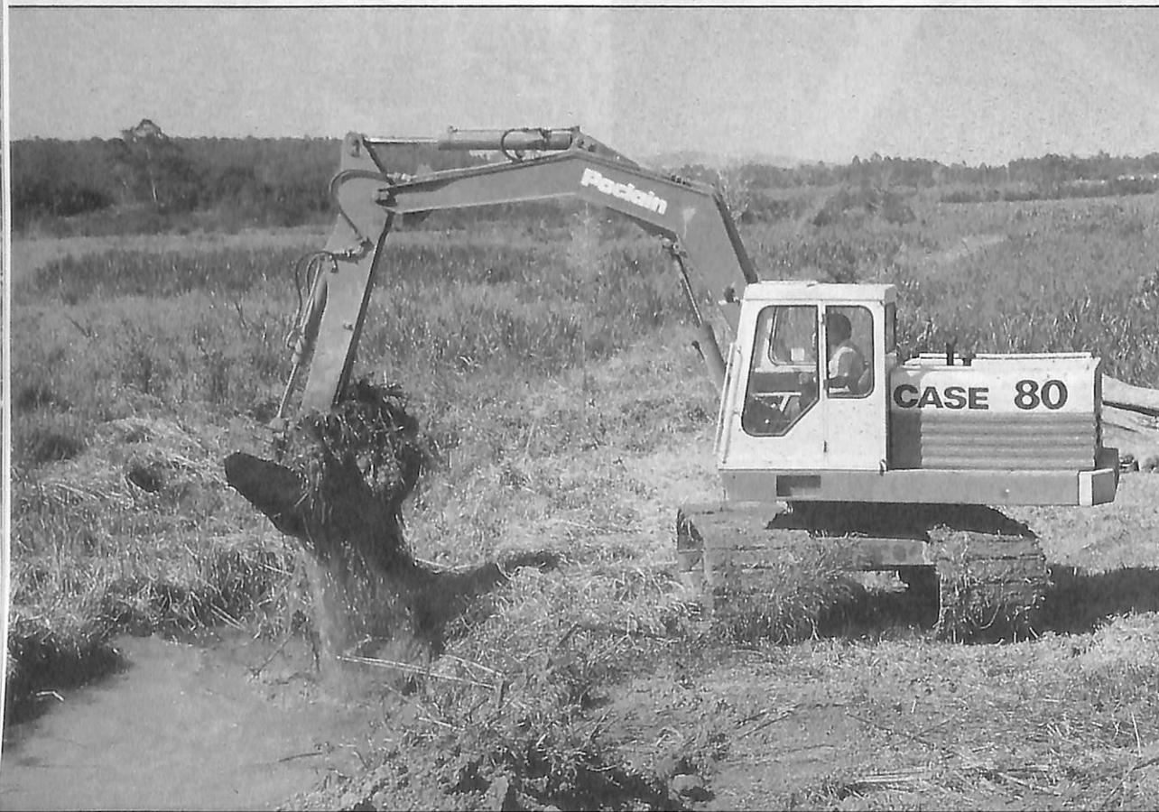
*Escavadora hidráulica: esteiras para flutuar sobre solos alagados e lança com giro de 360 graus*
