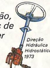
Direção Hidráulica Hidrostática 1973
