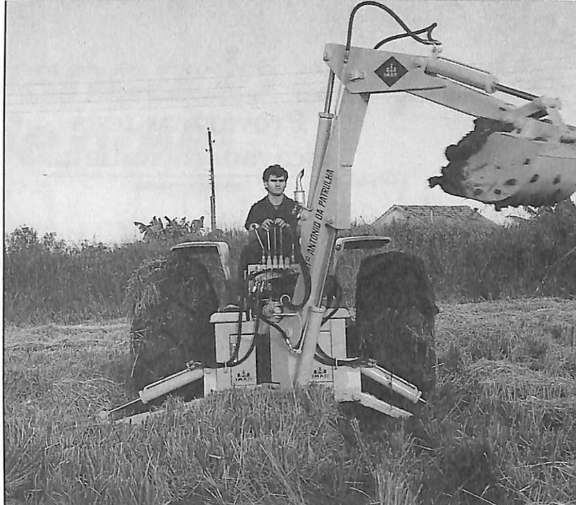
um equipamento para ser montado em tratores convencionais de rodas. É utilizado em pequenas obras de abertura e conservação de canais.
