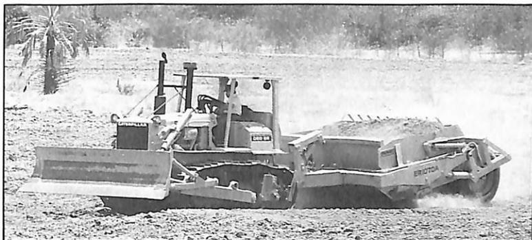
ladoras. Características: distância entre eixos — 3,78 metros; peso (lastreado) — 5,23 toneladas; comprimento da lâmina — 3,0 metros; altura da lâmina — 0,38 metro.
