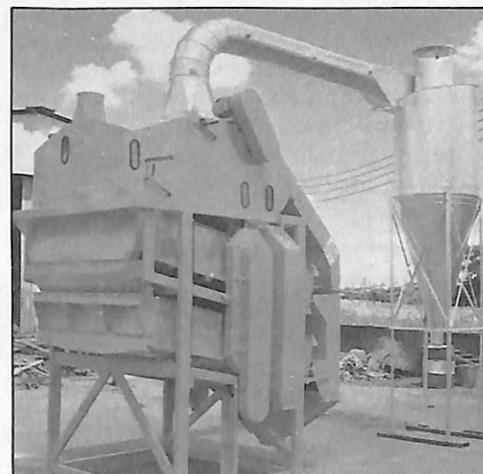
**Limpadora de cereal** — Em dois modelos: MPL-20 (para 20 toneladas por hora) e MPL-40 (para 40 toneladas por hora). Fabricada em chapas de aço-carbono, com fundo antiferrugem e acabamento em esmalte sintético. Composta por duas peneiras, bicas de ensaque para impurezas e de descarga para produtos beneficiados, motor elétrico blindado de 1,5cv e 1.750rpm. **Semical Ltda.**, Gleba Jacutinga, lote 335, CEP 86001, Londrina/PR.
