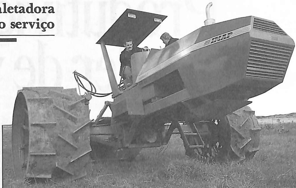
*Valetadora autopropelida: deslocando-se à velocidade de até 800m/hora*
