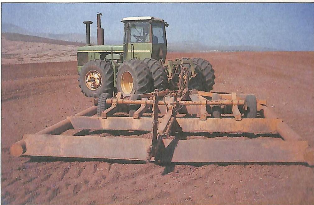
*Grande superfície de apoio mantém plaina niveladora em contato com o solo*
