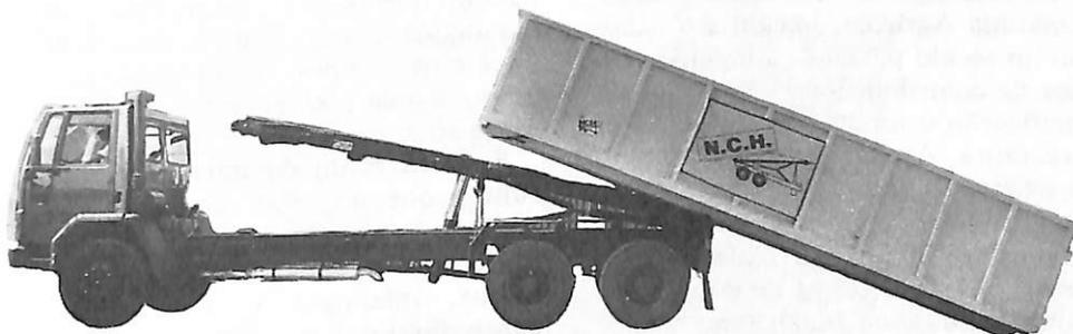
**Equipamento hidráulico** — Montado sobre chassi de qualquer marca ou modelo de caminhão, o equipamento carrega, descarrega e bascula com ângulo de até 72 graus qualquer tipo de carga líquida, sólida, gasosa, com até 30 toneladas de carga. De fácil manuseio, com apenas três controles acionados de dentro da cabine do caminhão. **NCH Equipamentos Hidráulicos do Brasil Ltda.**, rua Miguel Russo, 58, fones (0192) 96-1369 e 96-1445, telex (19) 2681 HEND-BR, CEP 13830, Santo Antônio da Posse/SP.
