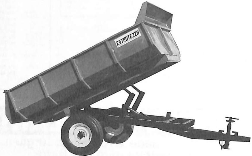
**Carreta basculante** — A carreta basculante hidráulica Bentlin D.T. 3.5 foi criada para transportar produtos a granel. Características: caçamba metálica de alta resistência, acabamento com anticorrosivo e esmalte automotivo, chassi super-reforçado, abertura automática da tampa traseira, entre outras. **Estrutezza — Estruturas Metálicas — Ind. de Perf. e Com. de Ferro e Aço Ltda**, via Anhangüera, km 224,5, CEP 13660, Porto Ferreira/SP, fones (0195) 81-2682 e 81-3666.
