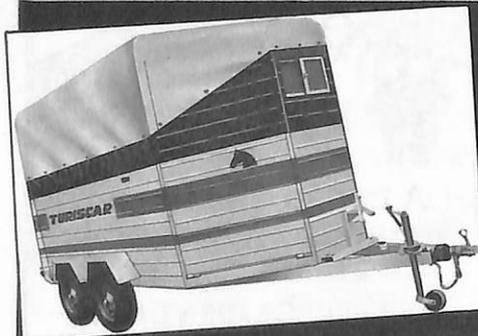
Especialmente projetado para transportar de dois a quatro animais de porte com facilidade e segurança, este modelo possui divisória e as laterais internas acolchoadas e o piso com pranchas transversais.
