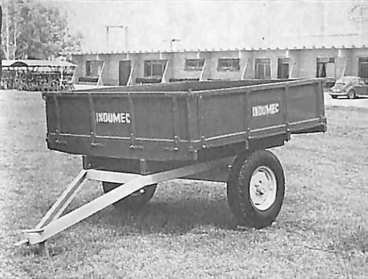
Modelo CAI 3000, da Indumec: um eixo que transporta até 3.000kg
