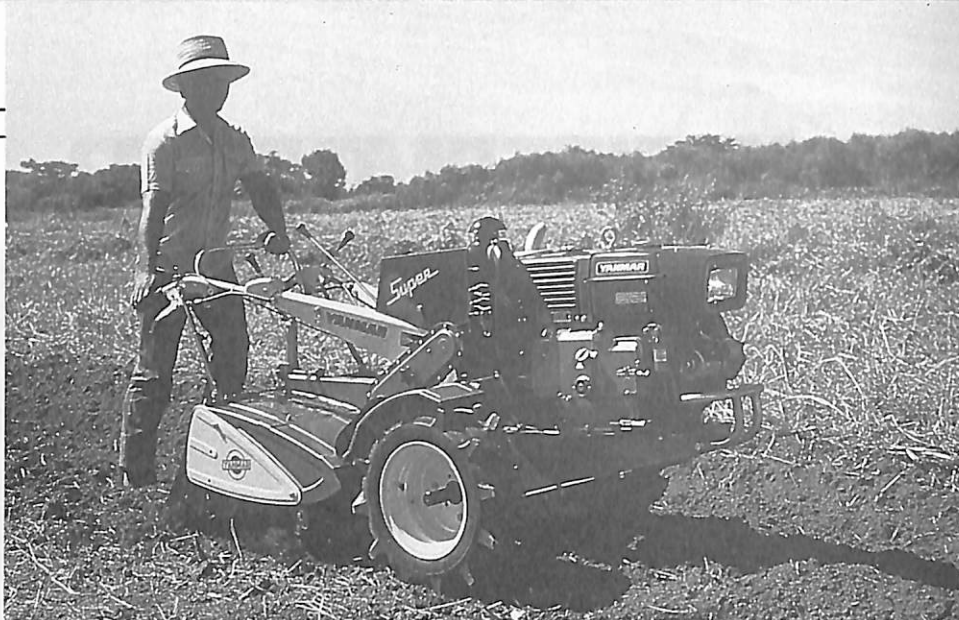
Motocultor com seu implemento característico, a enxada rotativa
