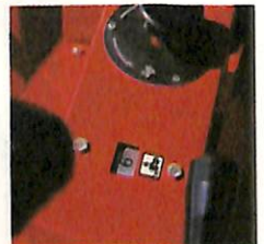
Controle de velocidade: Indicador de avanço, permite retomadas de velocidade programada.
