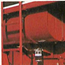
Maior autonomia: Novo tanque de combustível com 240 litros.
