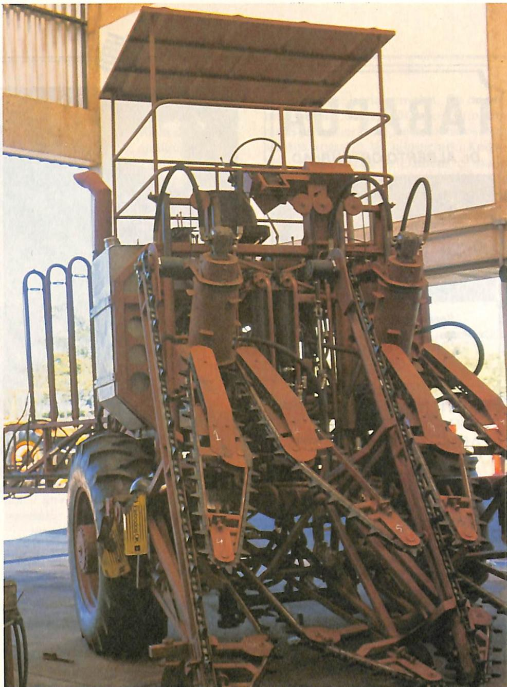
O protótipo do CTC: cortadeira de duas linhas com capacidade de corte de 120t/hora
