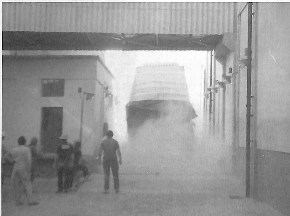
As moegas precisam ser dotadas de um sistema de captação do pó para proteger os trabalhadores na descarga.
