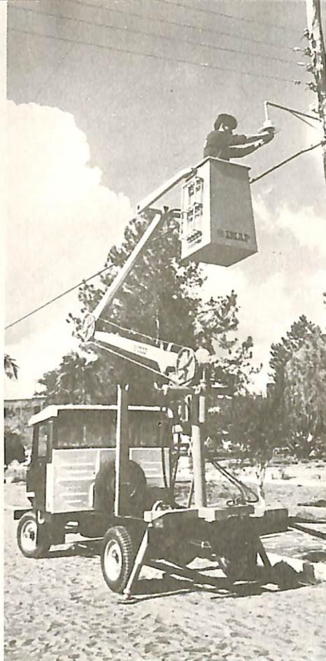
■ **Cesto aéreo** — O guindaste Imap acoplado em caminhão Tramontini, Kombi, F-4000 e outros, pode ser usado para a realização de serviços de eletrificação rural e urbana, poda de árvores e na montagem de estruturas metálicas, entre outras atividades. Além disso, pode ser útil no combate a incêndios. **Imap, rua João Manoel Fernandes, 165, fone (051) 662-1211, CEP 95500, Santo Antônio da Patrulha/RS.**
