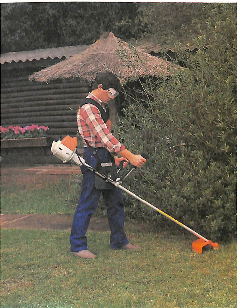
Roçadeira FS 220 operando com navalha de corte 3 pontas.
