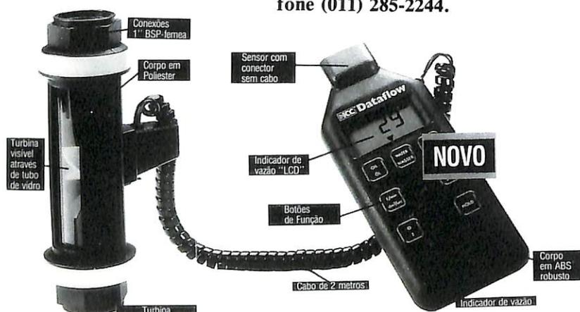
■ **Medidor de vazão** — O Dataflow é um monitor portátil digital que pode ser ligado a várias turbinas, uma em cada ponto que se deseja controlar. Vantagens apresentadas: o aparelho pode ser montado em qualquer posição e conta com um botão para opção entre água e óleo, e outro para leitura em l/min ou gal/min. As principais aplica-
