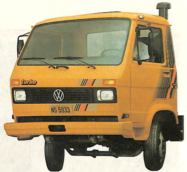
7.110S: motor MWM, peso bruto total de 6.700kg, chassi tipo escada rebitado a frio
