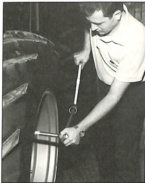
Método errado: transformar outra chave em braço de força. Embaixo, uso de chave de corrente tipo leve
