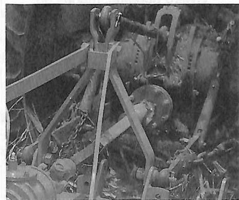
*Máquina montada com acoplamento direto ao engate de três-pontos do trator*
