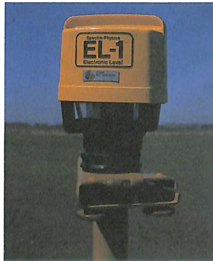
**Nível eletrônico gerador e transmissor de raio laser, um dos componentes do Sistema Laserplane**
