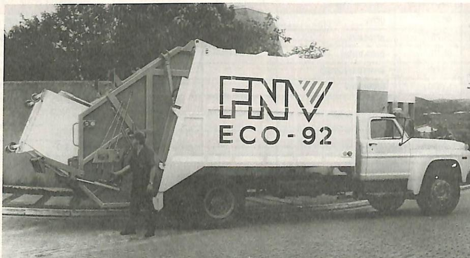
ao trabalho de descarga do lixo. Junto à prensa é instalada uma placa conveixa que impede o retorno do material coletado e compactado, da caixa para
