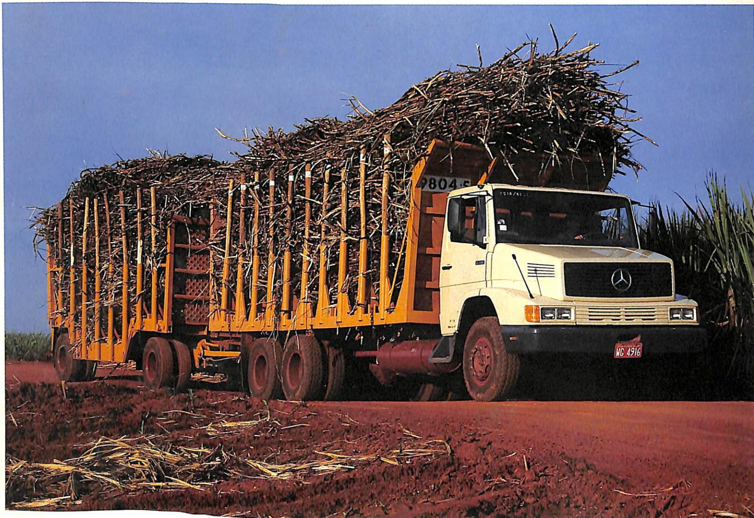
**UMA SOLUÇÃO ADEQUADA PARA O TRANSPORTE FORA DE ESTRADA.** Quem trabalha no campo sabe a importância de poder contar durante a colheita com um veículo especialmente desenvolvido para o transporte de cargas nas mais adversas condições de solo. Os caminhões semipesados e pesados Mercedes-Benz com 3º eixo de tração 6x4 são uma solução perfeitamente adequada para enfrentar desafios como terrenos irregulares e subidas de rampas com grande inclinação.
