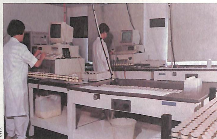
Analizador de proteína: o Bentley, equipamento de fabricação norte-americana, avalia 360 amostras por hora
