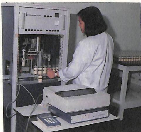
Fossomatic: através da contagem eletrônica, indica o número de células somáticas
