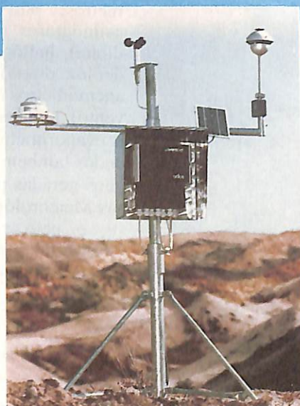
Estação automatizada: equipamento usado pelo Instituto Agrônomo de Campinas/SP
