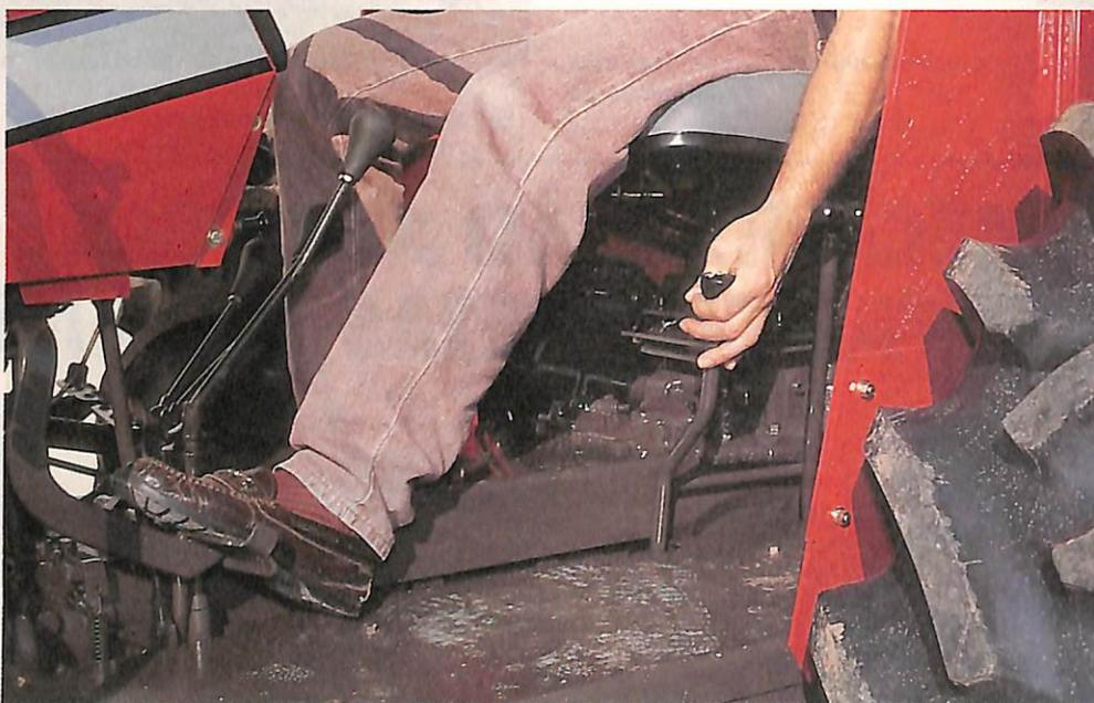
*Acoplamento da tração dianteira do trator*
