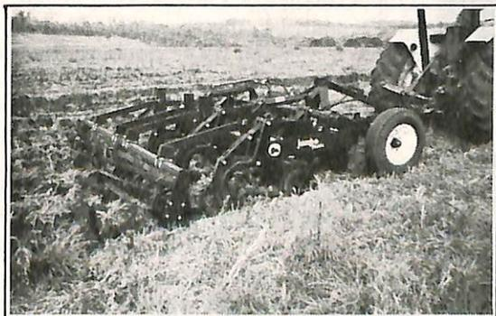
Projetado e produzido com tecnologia de ponta em implementos agrícolas, Jumbo Matic é um subsolador/escarificador automático que elimina a camada compactada sem desperdiçar os restos de cultura ou a adubação verde, dentro da mais moderna técnica de produção agrícola.
