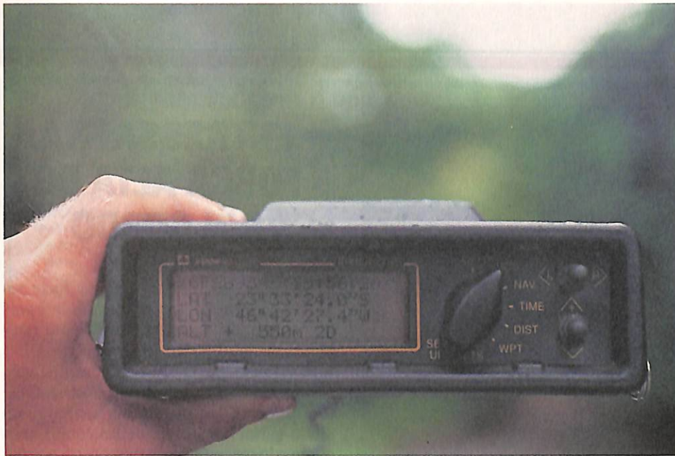
Receptor portátil para navegação: a antena já vem embutida
