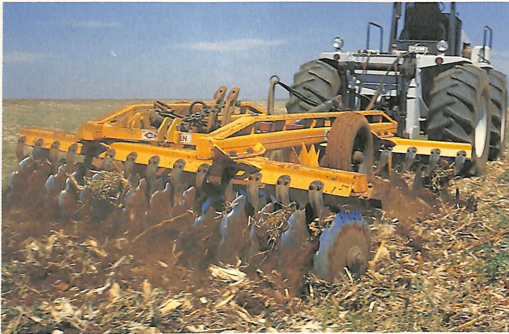
Grade aradora: discos recortados com diâmetro entre 24 a 36 polegadas
