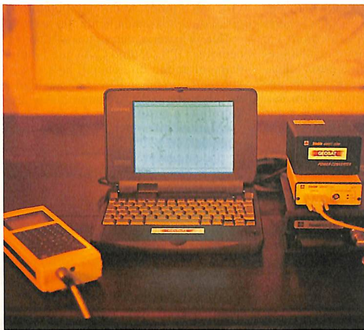
Receptor base: equipamento consiste de um receptor GPS, microcomputador, antena, cabos e softwares
