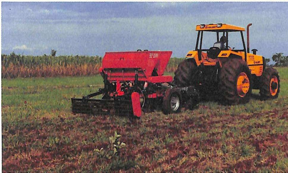
RP-2000, da Stara: subsolagem, aplicação de fertilizantes e semeio numa única operação
