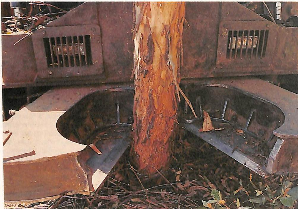
*A colheita: sistema de corte do feller buncher*
