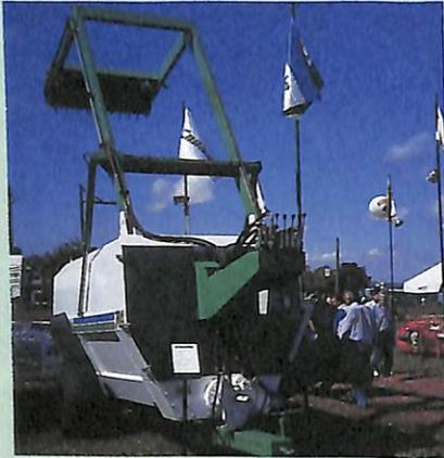
de silagem e lançadoras de esterco, a Casale apresentou a misturadora com balança eletrônica. O novo equipamento possui sistema computadorizado, que pode ser ligado diretamente a uma impressora. Além disso, a máquina replica e mistura feno e a silagem pré-secada de qualquer tipo de alimento (volumoso ou concentrado).
