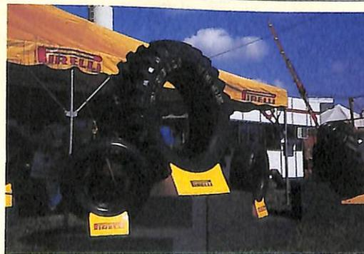
**Pirelli Pneus S/A, de São Paulo/SP** — O destaque ficou com os pneus TM 95 (para tratores e colheitadeiras) e o RA 45 (para implementos agrícolas). O TM 95 possui banda de rodagem dotada de barras alternadamente longas e curtas que favorecem o rodar, diminuindo as vibrações e oscilações transversais. O RA 45 é um pneu de estrutura diagonal, composto de quatro raias longitudinais, que conferem maior dirigibilidade à máquina e facilita a autolimpeza.
