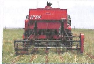
ROLO NIVELADOR: Realiza o nivelamento do solo e incorpora as sementes numa profundidade de 0 à 2cm.
