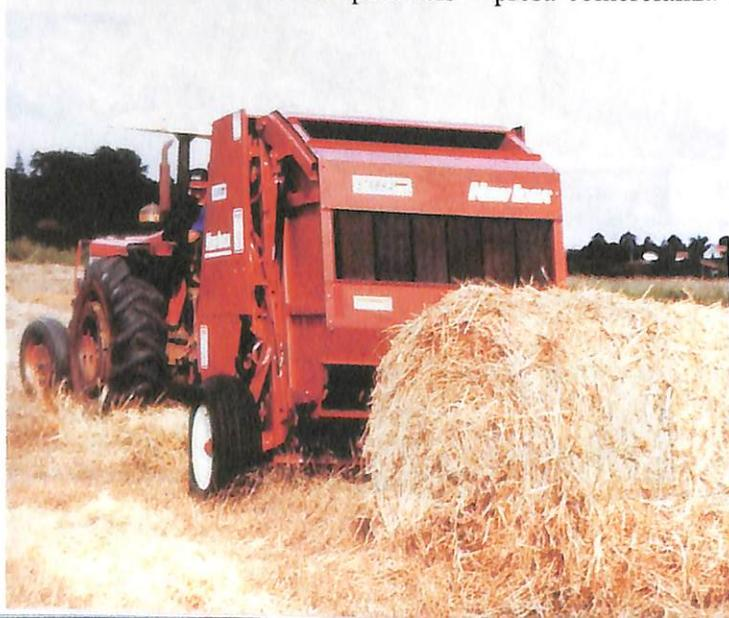
gulável. A máquina é acionada por trator de 35cv, com 540rpm.
