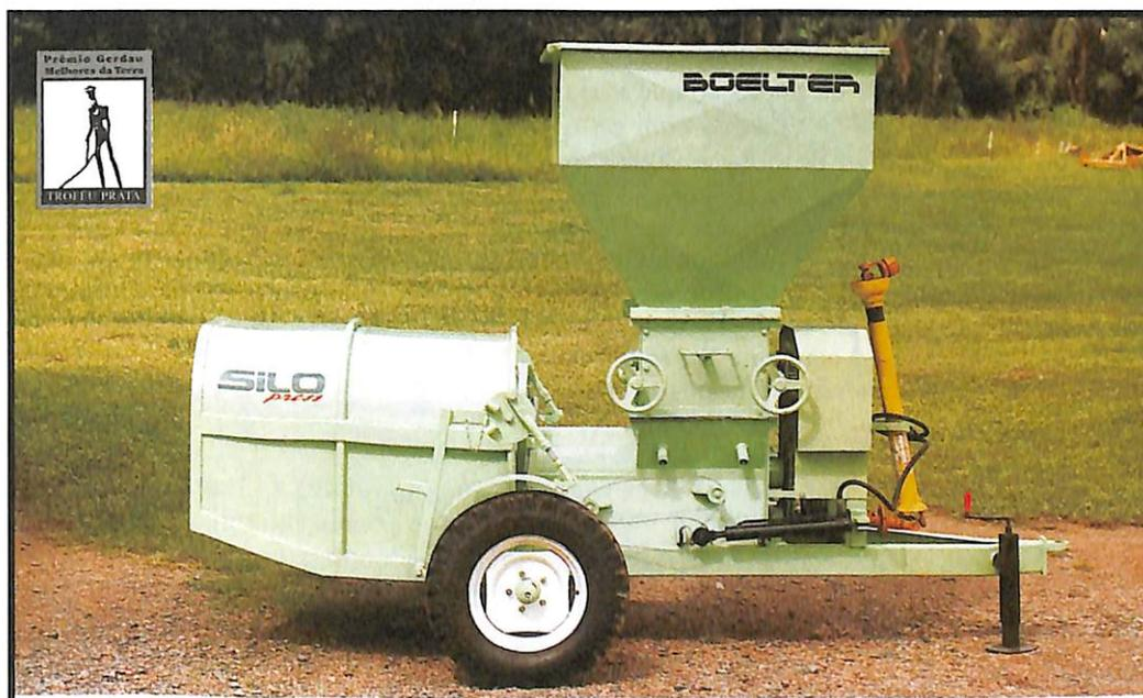
Com a Compra Programada você adquire agora o Silo Press que vai precisar usar no próximo ano. O Silo Press é um implemento que prensa o material verde picado (Kit Forragem) ou grãos úmidos (Kit Grãos), armazenando-o em um silo plástico específico para este fim. **Principais vantagens:** economia de mão-de-obra na operação de silagem • maior segurança na vedação do silo, evitando perdas pela exposição ao tempo • posição do silo variável, conforme necessidade de localização.
