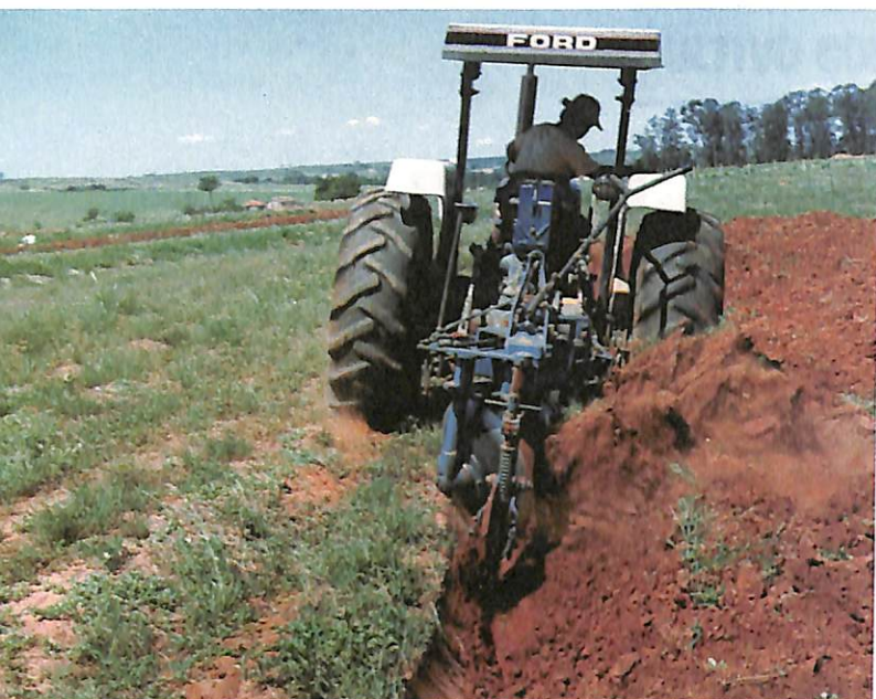
Arado de discos: variações em diâmetro, formato, afiação e tipo de borda
