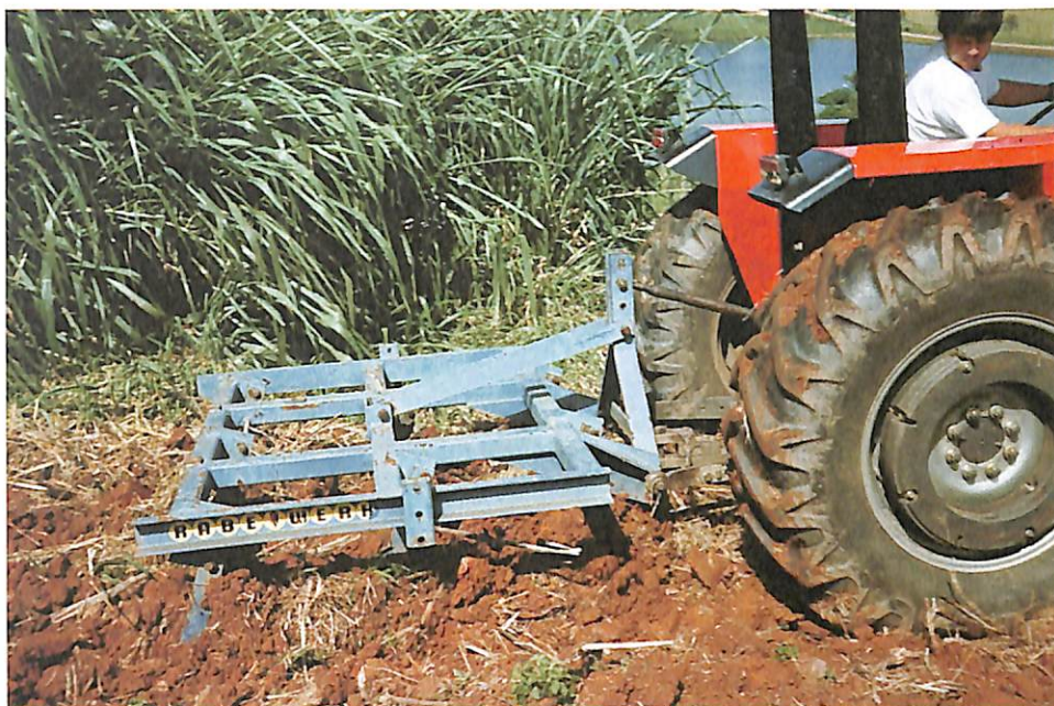
Subsolador em ação: equipamento robusto que penetra fundo no solo
