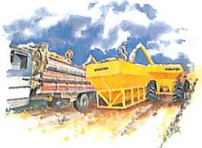
A famosa dupla da Boelter funciona assim: Graneleiro de Transporte leva os grãos até o Silo Móvel. Este descarrega no caminhão. Assim a sua colheita não para e você evita a perda de tempo e de grãos.
