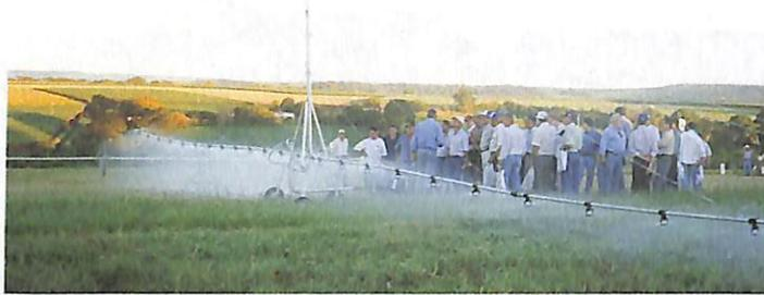
◀ O Powerroll Wade Rain é um sistema de irrigação rolante para ser utilizado em culturas de até 1,20m de altura, em terrenos com declividade de 30%. Possui tubos de alumínio com até 12m de comprimento.
