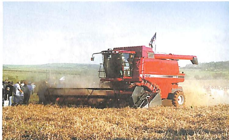
A Axial Flow 2388, da Case, demonstrou sua versatilidade nas dinâmicas no parque. Ela colhe feijão (foto), soja e milho. A máquina vem com o sistema axial de debulha, ideal para produtores de sementes; não possui saca-palhas e conta com tanque graneleiro com capacidade para 7.500 litros (95 sacas). A colheitadeira possui motor Cummins de 280cv.
