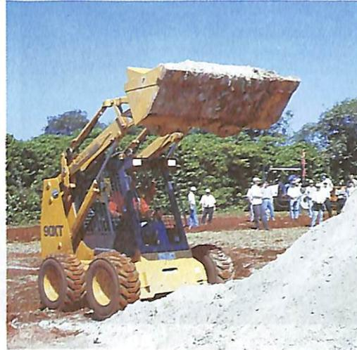
A pá-carregadeira modelo uniloader 90XT, da Case, está equipada com motor de 85cv e dotada de comandos por joysticks.
