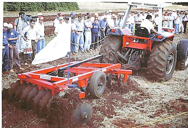
Starplan 3000, da Stara: possui navalha de corte de três metros de largura, possibilitando a construção ou desmanche de terraços, fechamento de barrocas e eliminação de ondulações no terreno.
