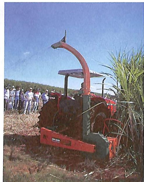
▶ Equipada com quatro rolos, duas facas circulares, quatro facas bimetálicas com afiador acionado pela bateria do trator, a forrageira CPF 2000, da Pinheiro, garante qualidade de corte do produto picado.
