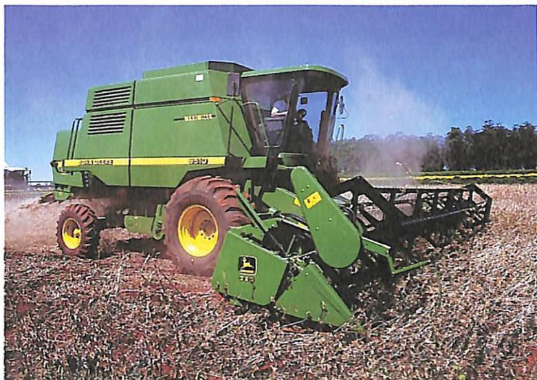
John Deere 9510: as áreas de separação e limpeza são dotadas de jato de ar por turbina de alta potência, garantindo maior eficiência ao processo. O motor é de 235cv. A plataforma de corte de 25 pés é ajustada por controle remoto da cabine de operação. Possui tanque graneleiro para 7.200 litros.
