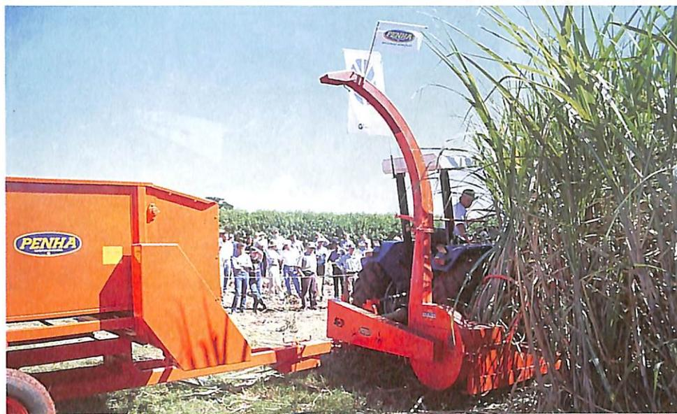
▲ Colhedora de forragem Master 50, da Penha: acoplável em tratores com potência mínima de 50cv, a máquina colhe até 20t/hora; possui dois discos com facas em aço que cortam a planta a garantem e alimentação contínua.
