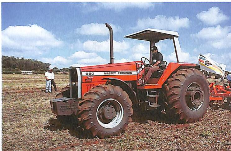
Da série 600 - Hidrotronic, o trator Massey Ferguson 660 da AGCO, vem com motor Perkins turbinado de 150cv, transmissão sincronizada com 12 marchas à frente e cinco à ré, e direção hidrostática. O sistema de freio é hidráulico.
