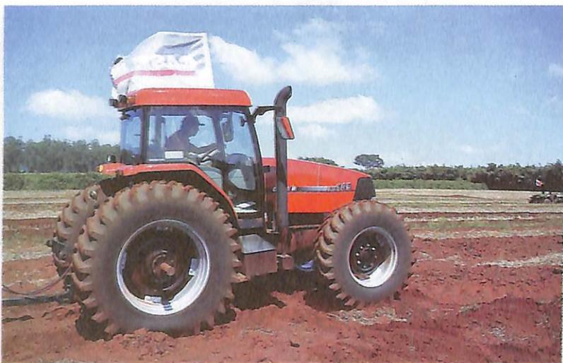
▲ *Equipado com motor Cummins de 135cv, o MX 135, da Case, possui câmbio com 16 marcas à frente e 12 à ré; cabine totalmente climatizada; e painel digital computadorizado multifunção, onde o operador controla o índice de patinação, velocidade percorrida etc. O sistema hidráulico de levante é de 3.500kg.*
