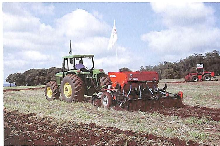
Terraceador Baldan TACR, de 22 discos: construção ou reforma de terraços de base larga de até 90cm de altura e nove metros de largura. Os pistões hidráulicos de dupla ação auxiliam na inclinação do cabeçalho e acionamento das rodas.
