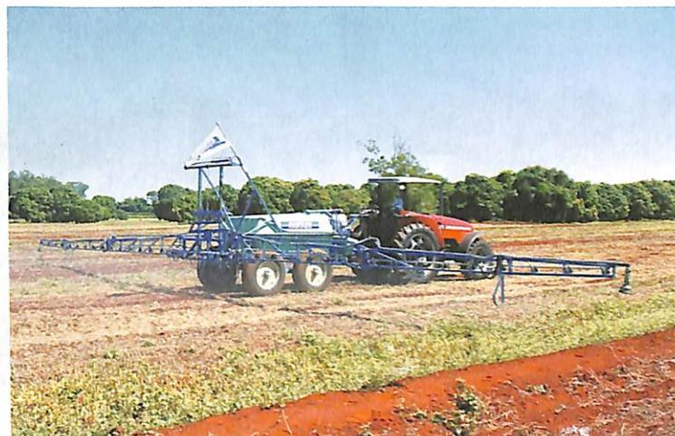
▲ O Uniport 2000, da Jacto, tem capacidade de trabalho de até 150ha/dia. O equipamento vem com motor Perkins, tanque de 2.000 litros, barra de 21m e vazão de 120 litros/min.
