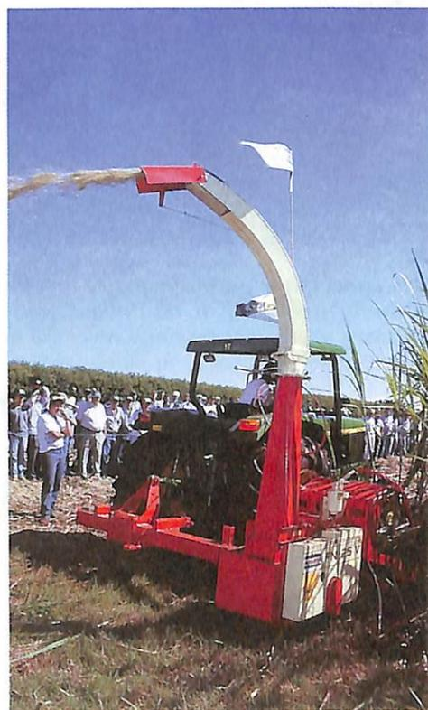
▶ A colhedora de forragens FN-25V, da Nogueira, está equipada com roda de apoio de descarga, afiador e oferece até oito opções de cortes precisos e uniformes.
