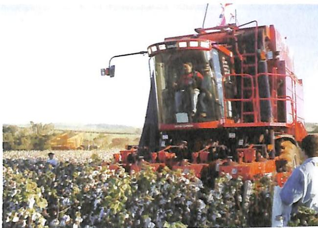
Com motor Cummins de 260cv, a colheitadeira de algodão Cotton Express 2555, da Case, é uma das maiores existentes no mercado. Possui cesto com capacidade de armazenar até 32,5m<sup>3</sup> de algodão. O equipamento vem com transmissão hidrostática de três velocidades, rodado duplo e freio de estacionamento controlado eletronicamente.
