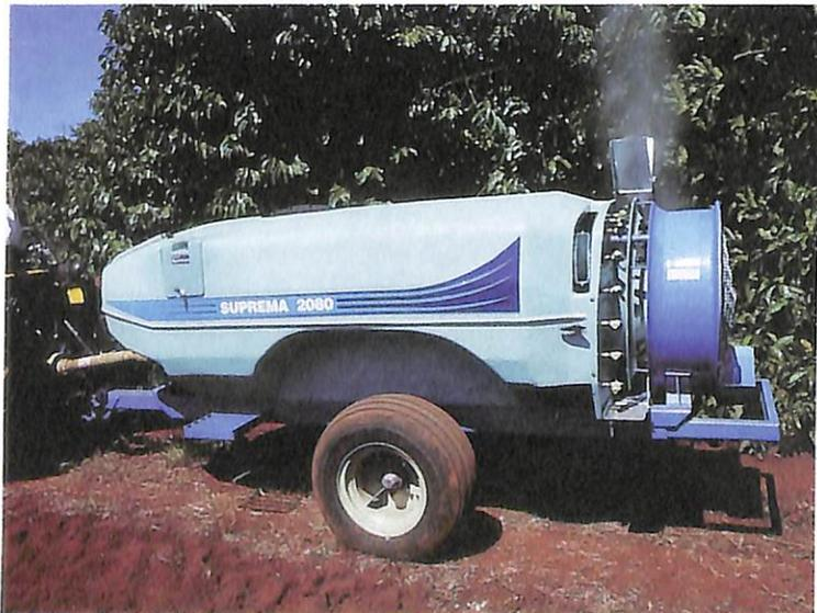
◀ *Ideal para café, o Suprema 2080, da Montana, tem capacidade de 1.500 litros, depósito de água limpa e turbina de 800 milímetros com embreagem centrífuga. A transmissão é por caixa de embreagem com duas velocidades.*
