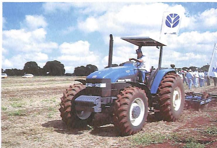
◀ *O trator TM 140, com motor de 140cv, é o mais potente entre os modelos da nova série mundial da New Holland, a TM. A máquina está equipada com transmissão Shuttle Command com disco de embreagem simples e câmbio sincronizado com 16 marchas à frente e 16 à ré.*
