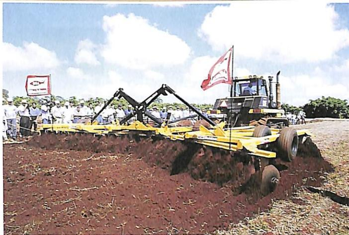
O subsolador AST/MATIC 650, da Marchesan, rompe camadas compactadas de até 60cm de profundidade. Possui desarme automático das hastes e ponteiros reversíveis especiais.
