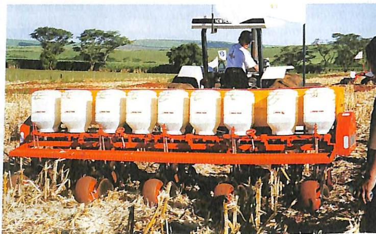
A Fankhauser 1016, com sete linhas para a soja, possui dosador com discos horizontais e acompanha todas as ondulações do terreno graças ao sistema de braços pantográficos.
