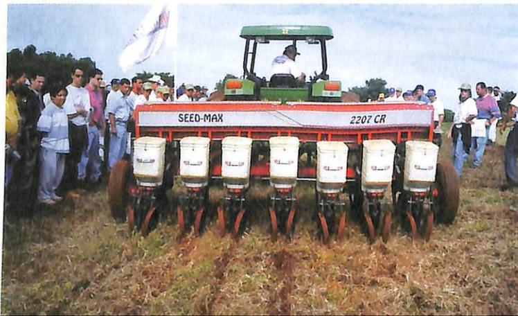
◀ Com sete linhas para a soja e quatro para o milho, a plantadeira Seed-Max 2207CR, da Max, vem ainda com depósito de adubo com capacidade de 570kg e conjunto disco de corte e sulcador desencontrados.
