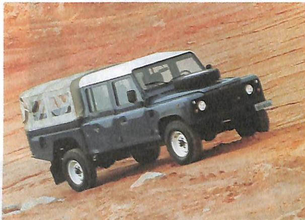
▲ No estande da Land Rover, todos queriam conhecer o Defender 4x4, produzido com carroceria de alumínio e chassi reforçado; freio a disco nas quatro rodas; e suspensão de longo curso.
