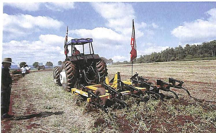
◀ O arado escarificador Baldan AETCR/D, de 11 hastes, é dotado de uma mola em cada uma das hastes que proporciona vibrações durante a operação. Isso faz com que a mesma retorne automaticamente na posição de trabalho após impactos contra obstáculos.
