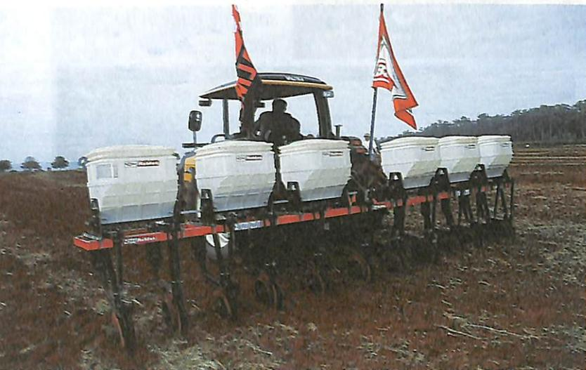
▲ *Com seis adubadeiras e 12 discos duplos montados em armação de vigas tubulares, o adubador ACD, da Baldan, tem depósitos duplos anticorrosivos, com capacidade da carga de até 110 litros cada. O ACD pode ser usado tanto em sistema PD como convencional.*
