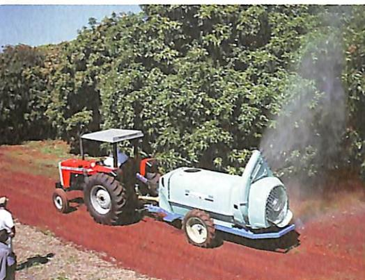
◀ A turbina de 840mm do Omega Citrus, da Montana, produz 70.000m<sup>3</sup> de ar por hora, com velocidade de 160km/h. A bomba atinge vazão de 160 litros/min e o tanque tem capacidade de 2.000 litros.
