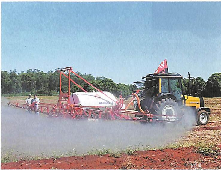
◀ *K.O. CROSS-S: possui tanque com capacidade de 2.000 litros e barra de 18m com levante hidráulico. A bomba tem capacidade de vazão de até 150 litros/min. O comando possui retorno individual para cada parte da barra.*
