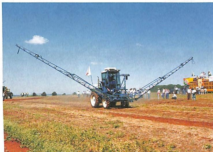
▲ O pulverizador autopropelido Max-System, da Max, é uma fusão de trator e pulverizador. Isso permite menor contato do operador com o produto químico e, também, trabalho noturno.
