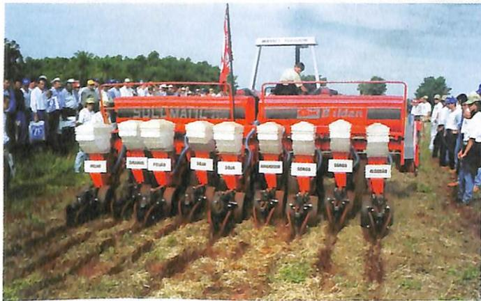
▲ Solomatic 4500, da Baldan: plantadeira de precisão com dosadores de sementes pneumáticos de tambor rotativo para todos os tipos de grãos, em linhas pantográficas desencontradas e independentes.
