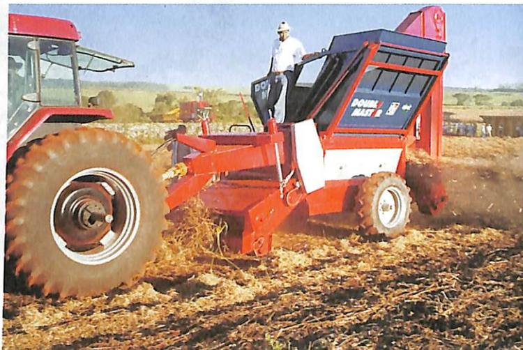
A recolhadora de feijão Doble Master, da Colombo, colhe, bate e ensaca feijão e amendoim. O equipamento possui sistema de fluxo axial de baixo impacto e ainda vem com tanque graneleiro.
