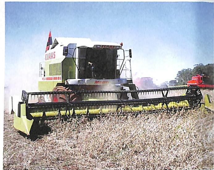
▲ Fabricada pela montadora alemã CLAAS, a colheitadeira de grãos Mega 204 é equipada com motor de 200cv. A máquina vem com seis saca-palhas e sistema de trilha APS (Acelerador de Prévia Separação), que evita a sobrecarga sobre o cilindro, uniformizando o fluxo de material. A Valtra, fabricante dos produtos Valmet, é a representante da CLAAS no Brasil.
