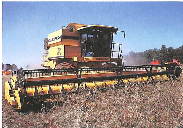
Com motor turbinado de 270cv a TR 98, da New Holland, vem com sistema de separação com rotor duplo localizados na parte dianteira do sistema industrial. O equipamento reduz a quase zero o dano mecânico nos grãos, proporcionando maior eficiência no processo de colheita.
