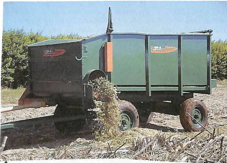
▲ Com capacidade para até quatro toneladas de material, o vagão forrageiro VP-6, da Pinheiro, vem com placa protetora da rosca sem-fim e reversão da descarga lateral para a traseira mesmo em movimento.
