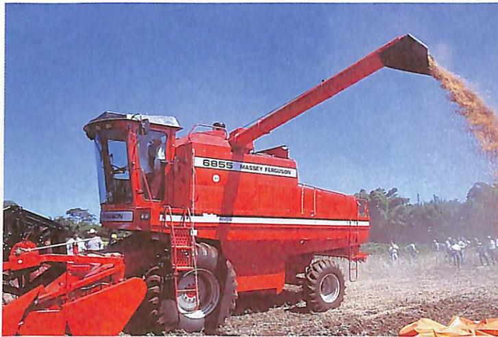
210cv, seis saca-palhas e com tanque de armazenagem de até 5.000 litros.
