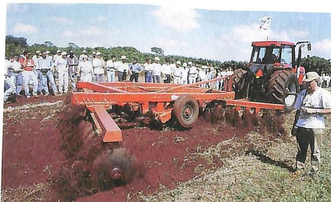
◀ Grade aradora intermediária com controle remoto SAC-40, da Civemasa, é ideal para nivelamento de solo na cultura da cana. É equipada com quatro cubos e rodas independentes.
