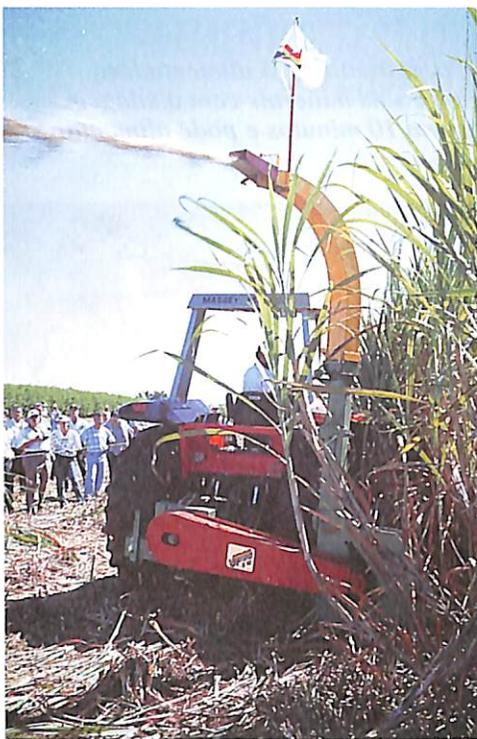
▲ JF 90Z10, da JF: possibilita 12 tamanhos de corte de qualquer tipo de forrageira; possui facas em forma de Z com aço tungstenado que garante maior durabilidade de corte e menos afiação.
