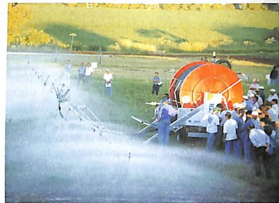
▶ Rainstar TX 90, da Bauer: sistema com carretel enrolador, com barra de spray. A turbina axial proporciona a perda mínima de pressão.
