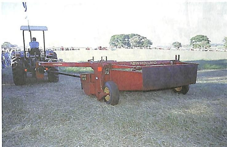
▲ Segadeira condicionadora New Holland 1412: vem com sistema modular de barra de corte. Os rotores, com duas facas, são acionados por módulos independentes, e o condicionamento do material é feito por dois rolos com martelo.
