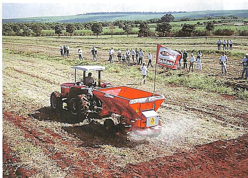
▲ O distribuidor de calcário e fertilizantes DCF 6000, da Baldan, tem rodado em tandem com rótula de articulação que diminui a compactação do solo; sistema de distribuição por corrente e caixa redutora, dispensando o uso de correias.
