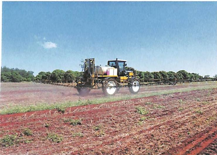
▲ *Com motor Cummins turbinado de 200cv, seis cilindros e tração nas quatro rodas, o Rogator 854, da norte-americana AG-CHEM Equipment, tem barras de até 27m de largura e pode atingir velocidade de até 30km/h. A capacidade do tanque é de 3.000 litros.*
