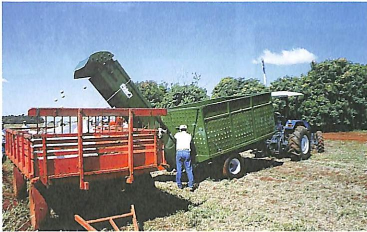
Carreta Bean, da Fido: desenvolvida especialmente para a colheita de laranja, o veículo é autocarregável, capacidade de transporte de 216 caixas de 26kg, elevador de esteira por corrente ou lona e tempo de descarga de no máximo 10 minutos.
