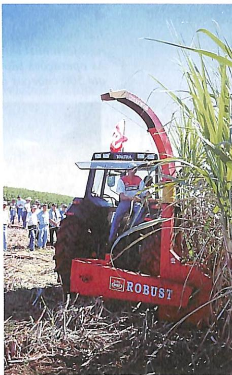
▲ A Colhimenta Robust, da Menta Mit, colhe milho, sorgo, cana-de-açúcar, napier e camerum. Está equipada com rotor em aço de alta resistência, todo montado com parafusos em aço 10.9.
