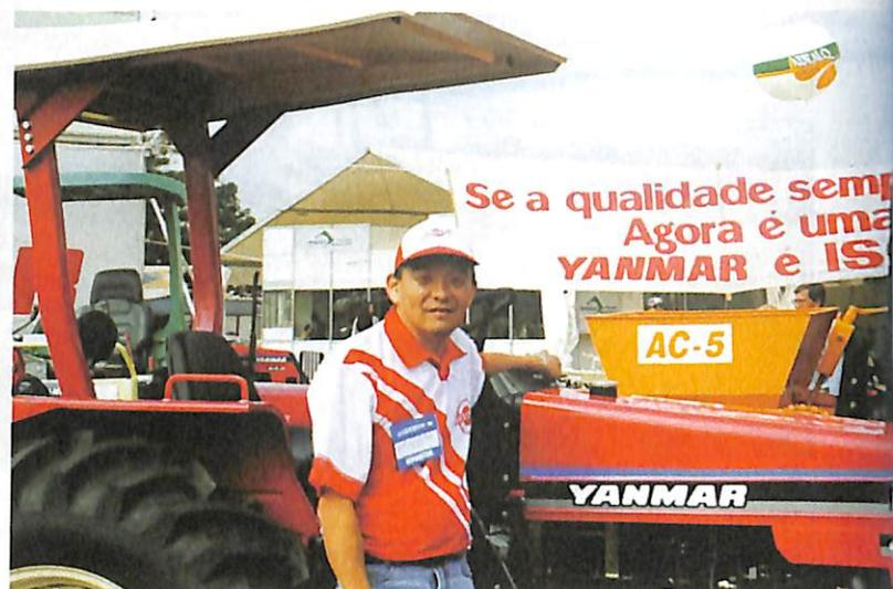
Apesar de ausente das dinâmicas, a Yanmar mostrou em seu estande a linha de tratores para fruticultura e grãos. Destaque para o Yanmar 1050D, na foto junto ao gerente comercial da empresa, Nelson Watanabe. Equipado com motor de 40cv, tração 4X4, o trator vem com direção hidrostática.
