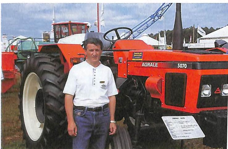
O Agrale 5070, de 70cv, (na foto com o gerente de vendas de tratores, Valter Loss) também passou longe das dinâmicas neste Agrishow. O trator, fabricado em parceria com a Zetor, da República Tcheca, possui capacidade de levante de até 2.600kg, acionamento hidráulico e direção hidrostática.
