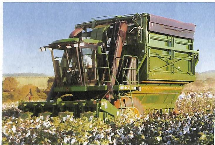
Colheitadeira de algodão John Deere 9970: motor de 250cv; pode ser equipada com quatro ou cinco linhas, com espaçamento de 30 a 40 polegadas; possui transmissão hidrostática de três velocidades; e sistema de lubrificação centralizado, com acionamento frontal.
