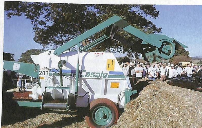
▲ Pecos 9004, da Nogueira: tem opções de corte entre cinco e 14mm. Possui dispositivo de acionamento da bica de descarga, roda de apoio, afiador e pino de segurança. Produz até 20t/hora de forragem.
