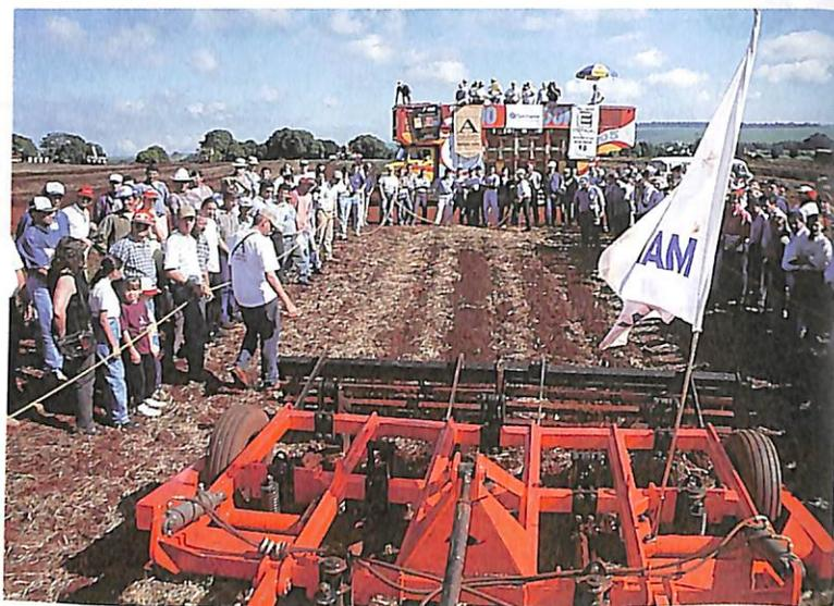
▲ O arado subsolador AST/MATIC com sete hastes, da Marchesan, rompe camadas compactadas de até 45cm de profundidade. É equipado com sistema de desarme automático das hastes.
