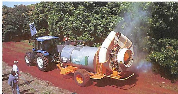
▲ Com tanque de 4.000 litros e bomba de vazão de 300 litros/min, o Arbus 4000, da Jacto, é um dos maiores pulverizadores do setor. Trata árvores frutíferas com até 9m de altura. Possui motor Perkins de 115cv, para mover seus dois ventiladores.
