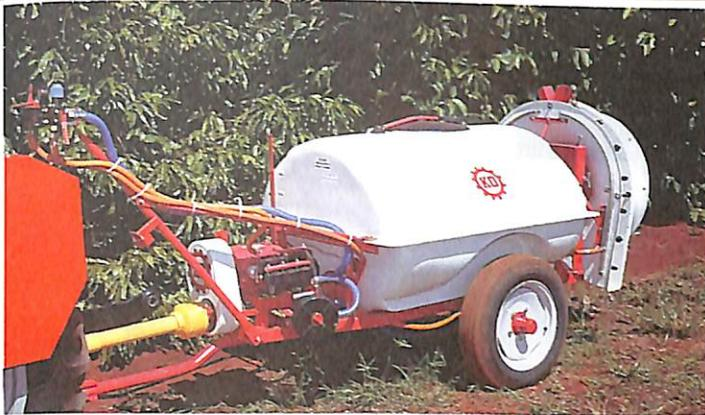
▲ Desenvolvido para cafezais de pequeno e médio portes, o K.O. 700-CA vem com tanque para 700 litros, turbina de 730mm, com 14 bicos dirigíveis fixos. A bomba tem vazão de 45 litros/min.
